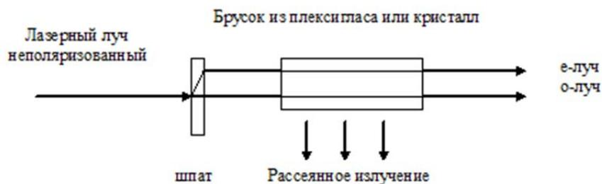
**Рис. 3.** Схема наблюдения рассеянного излучения с использованием шпатового расщепителя
