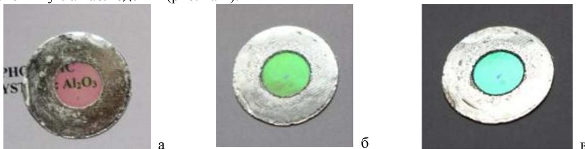
**Рис.1.** Внешний вид поверхности фотонно-кристаллических плёнок при различных геометриях наблюдения
