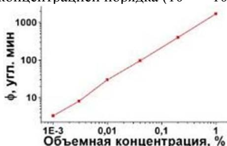
**Рисунок.** Зависимость амплитуды откликов при  $H=45$  Э от концентрации наночастиц
