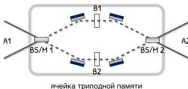
**Рис. 2.** Аналогия ячейки триподной квантовой памяти и интерферометра Маха-Цендера:
